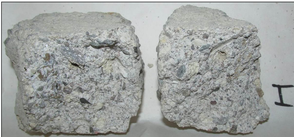
Foto 16: Celkový pohled na části vzorku I před zkouškou na přítomnost ASR
