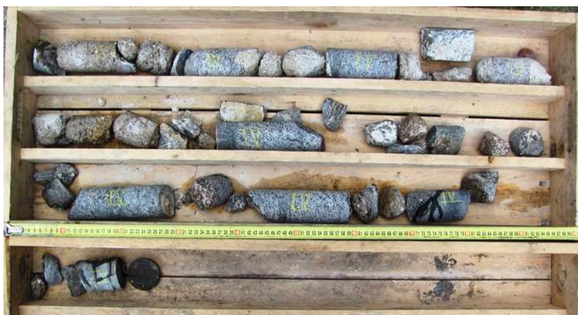
IV – odebraný vzorek jádra z pravé části koruny hráze
