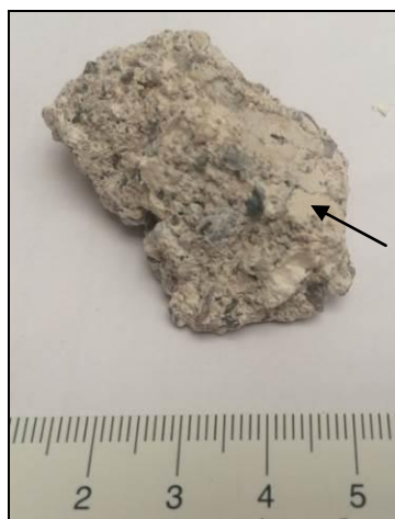
Foto 19: Místo odběru pojiva z malty pro termickou analýzu
