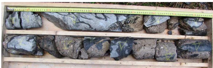
V – vodorovný odebraný vzorek jádra ze vzdušní strany hráze
