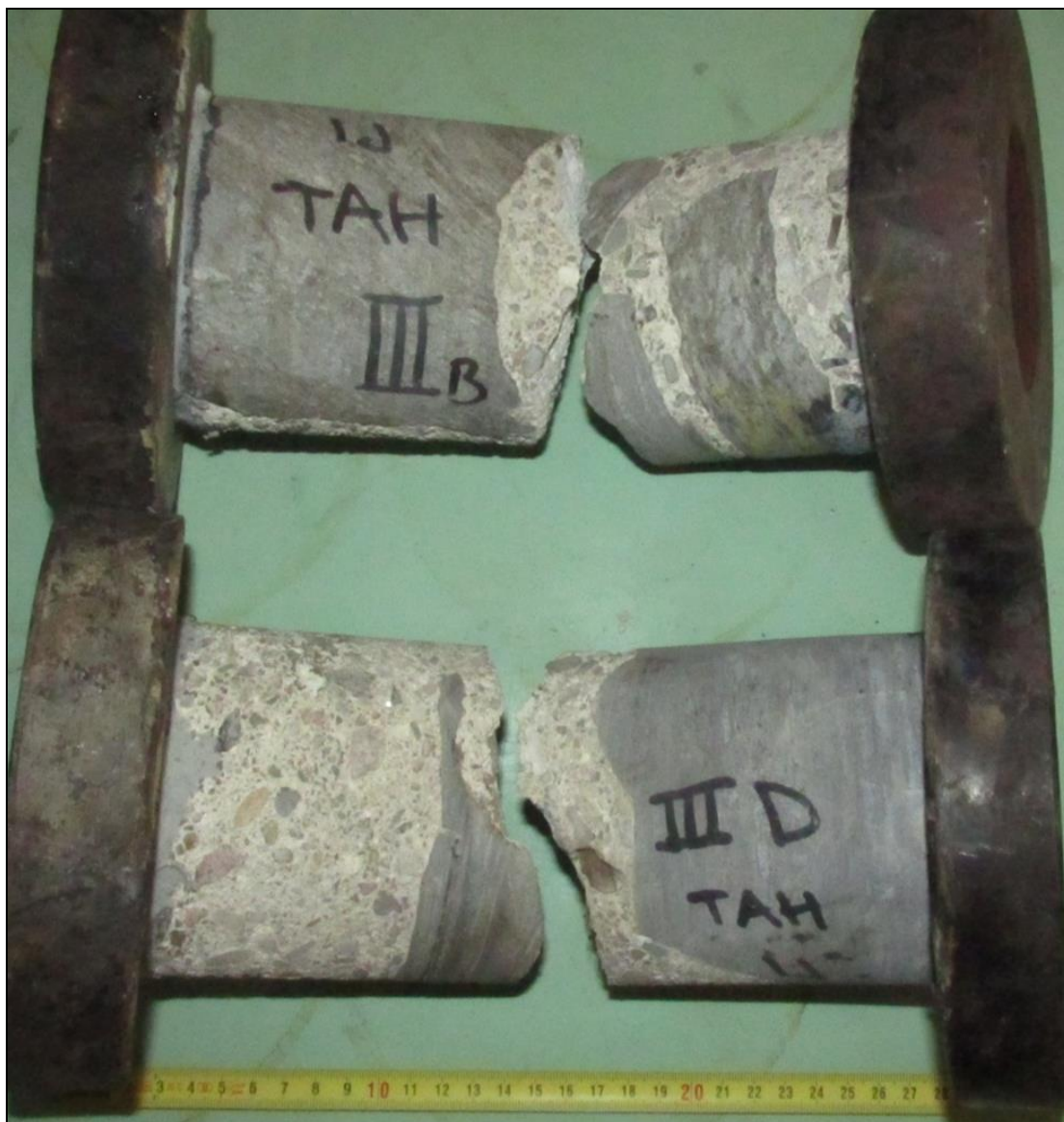
Foto 14: Vývrty III-B a III-D po zkoušce v prostém tahu
