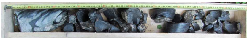
VI – odebraný vzorek jádra z šikmého vrtu do vzdušní paty hráze
