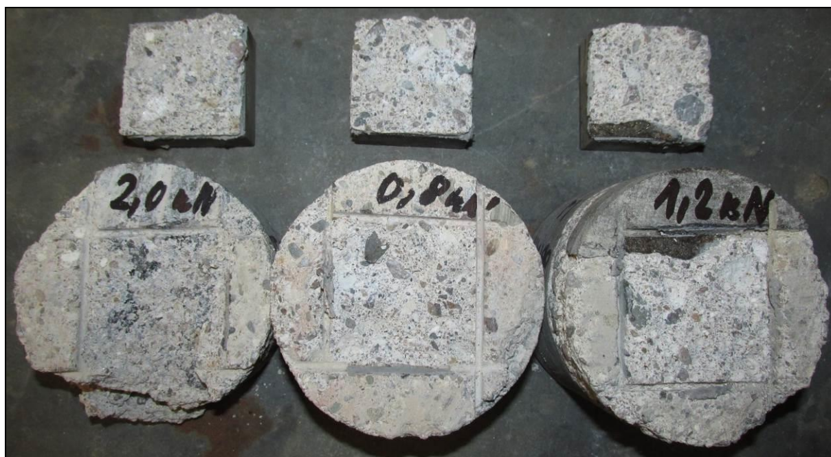
Foto 15: Čela vývrtů II-B, III-C a III-E po zkoušce v prostém tahu
