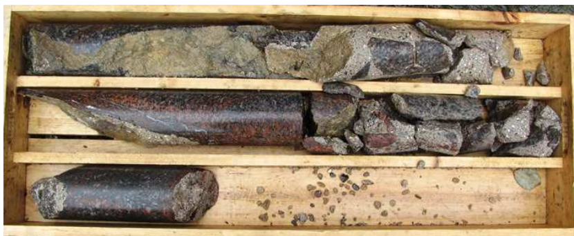
VI – odebraný vzorek jádra z návodní strany hráze.
