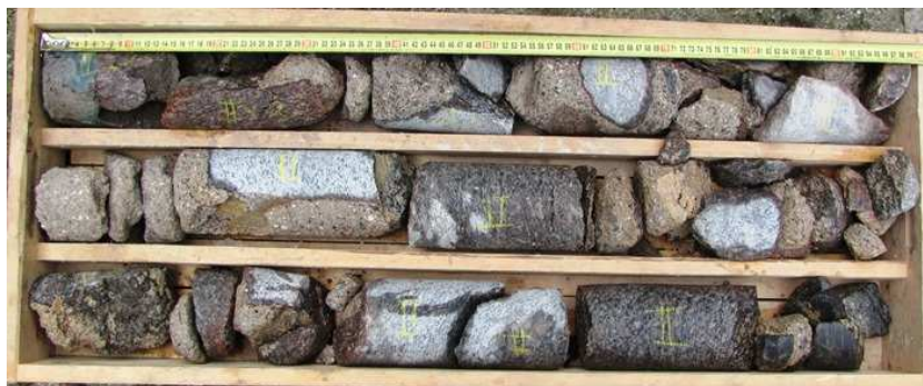
V II – odebraný vzorek jádra z levé části koruny hráze
