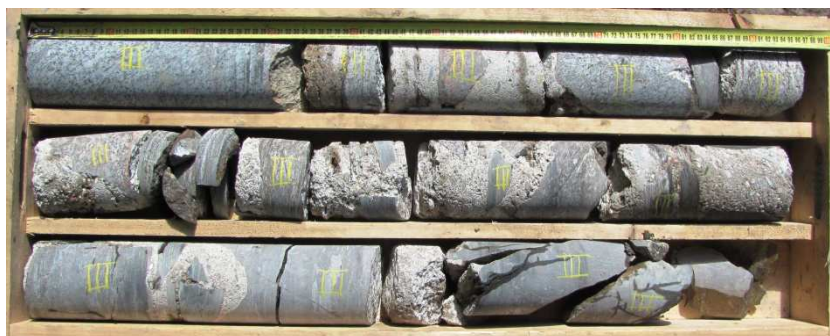
III – odebraný vzorek jádra z pevné přelivné části bezpečnostního přelivu
